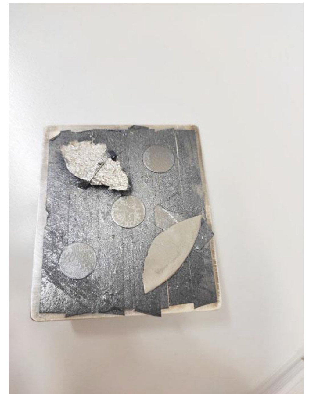
Образцы бактериальной целлюлозы и биокompозита
