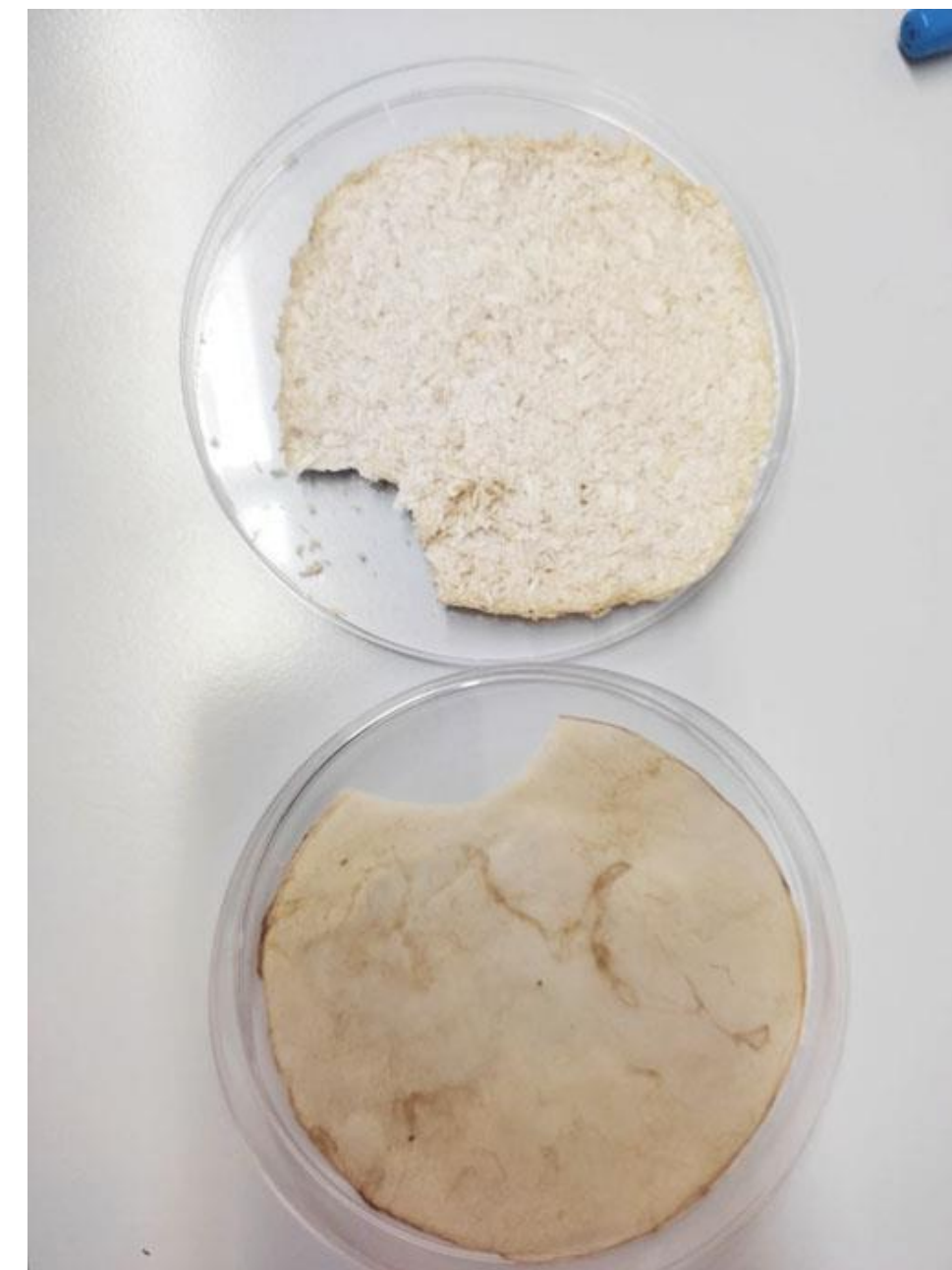
Образцы бактериальной целлюлозы и биокompозита
